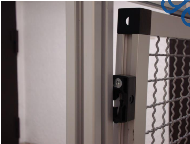
Bild 1: Zaunklicksystem. Nach Öffnung verbleibt Zaunelement nicht in Schutzstellung
